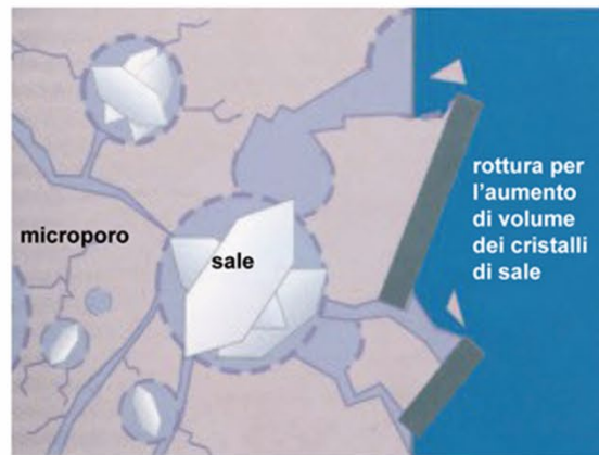
INTONACO TRADIZIONALE SATURO D'ACQUA
