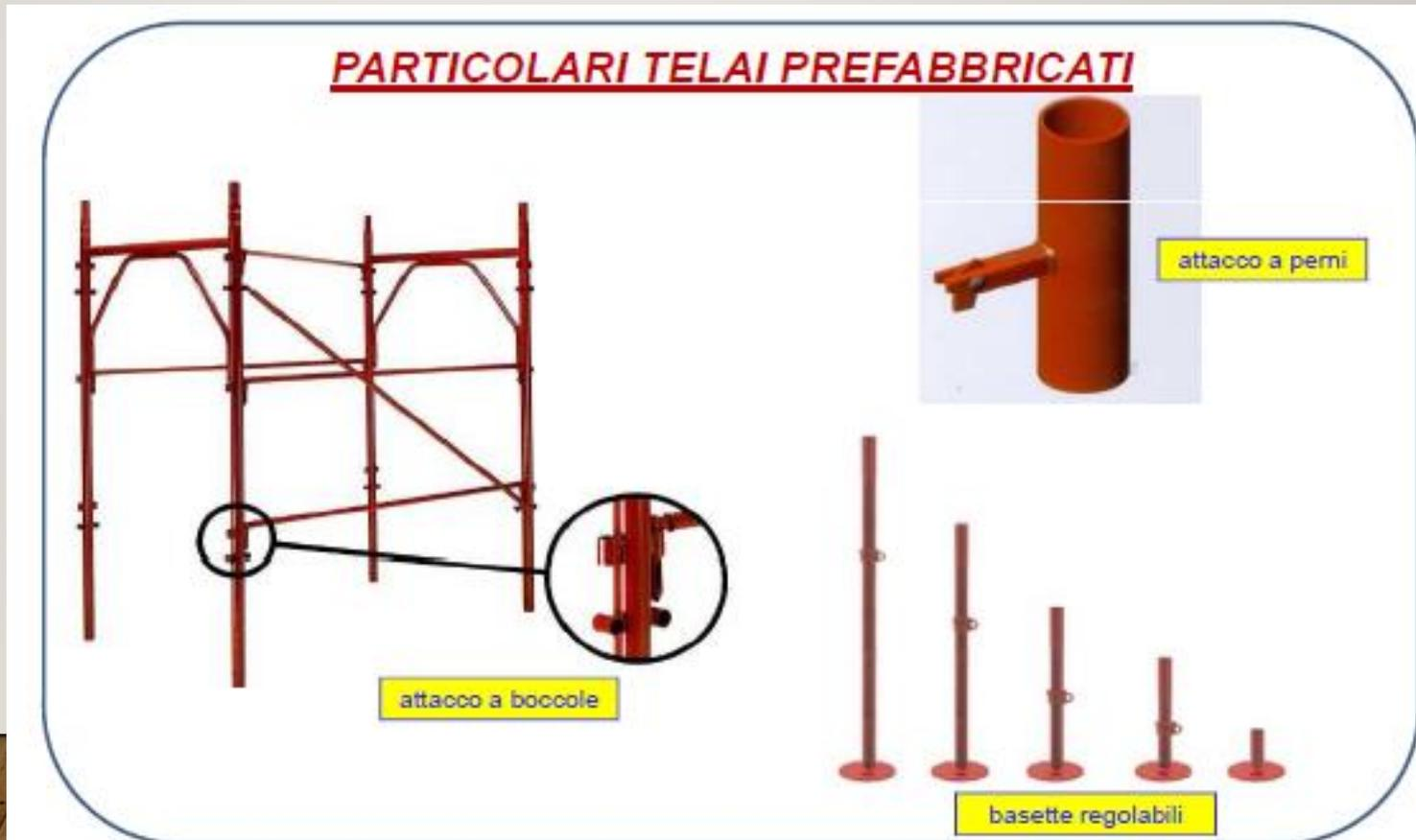
PONTEGGIO A MONTANTI E TRAVERSI PREFABBRICATI (MULTIDIREZIONALE) PMTP \_ sono costituiti da elementi prefabbricati costituiti da tubi da disporre verticalmente provvisti di specifici sistemi di innesto (piattelli, boccole o staffe a 4, 6 od 8 vie) nei quali vengono innestati i traversi e i correnti prefabbricati: questa tipologia di ponteggi presenta i vantaggi di entrambe le tipologie prima viste, ma allo stesso tempo unisce la limitazione tipica dei sistemi prefabbricati.
