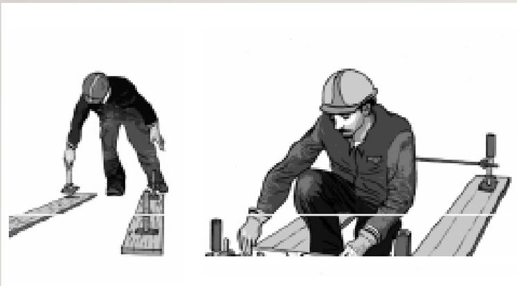
.6 Modalità di tracciamento del ponteggio, impostazione della prima campata, controllo della verticalità, livello/bolla del primo impalcato, distanza tra ponteggio (filo impalcato di servizio) e opera servita, ...
